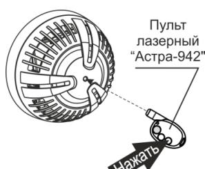
**6** Запуск регистрации извещателя с помощью вилки **Reg** и кнопки **вскрытия**:
