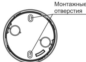
**3** Установить электронный блок извещателя в закрепленную базу:
