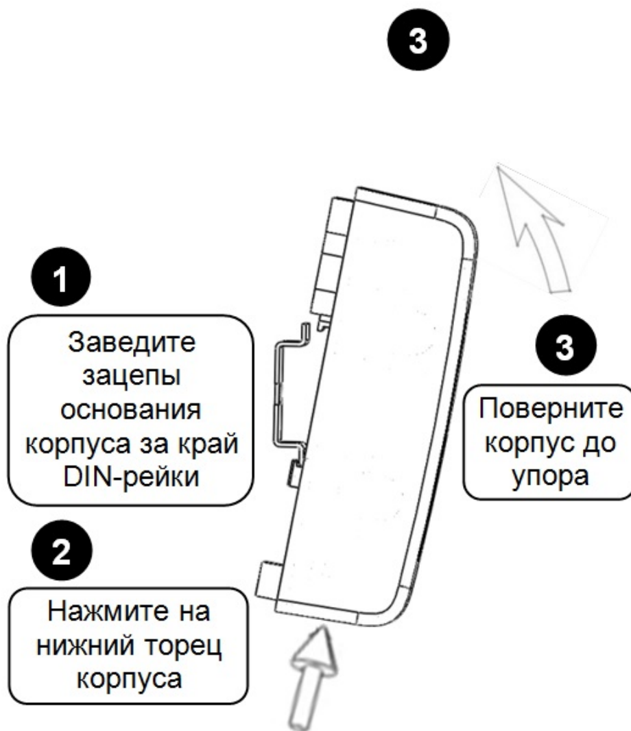
Рисунок 4. Крепление «УО-4С исп.02» на DIN-рейку
