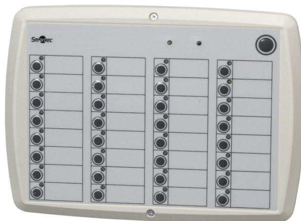
Сетевая панель ST-NC032 предназначена отображения статуса и управления различными элементами интегрированной системы безопасности, например, разделами охранной сигнализации. Она может использоваться совместно с контроллерами ST-NC221 и ST-NC441. Устройство имеет 32 свободно программируемых элемента световой индикатор/кнопка и порт для подключения считывателя для авторизации сотрудника при выполнении каких-либо операций.
