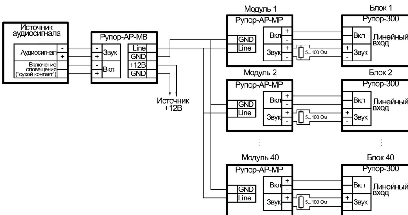
Рисунок 2.2.5. Схема подключения комплекта «Рупор-АР» к блоку «Рупор-300».
