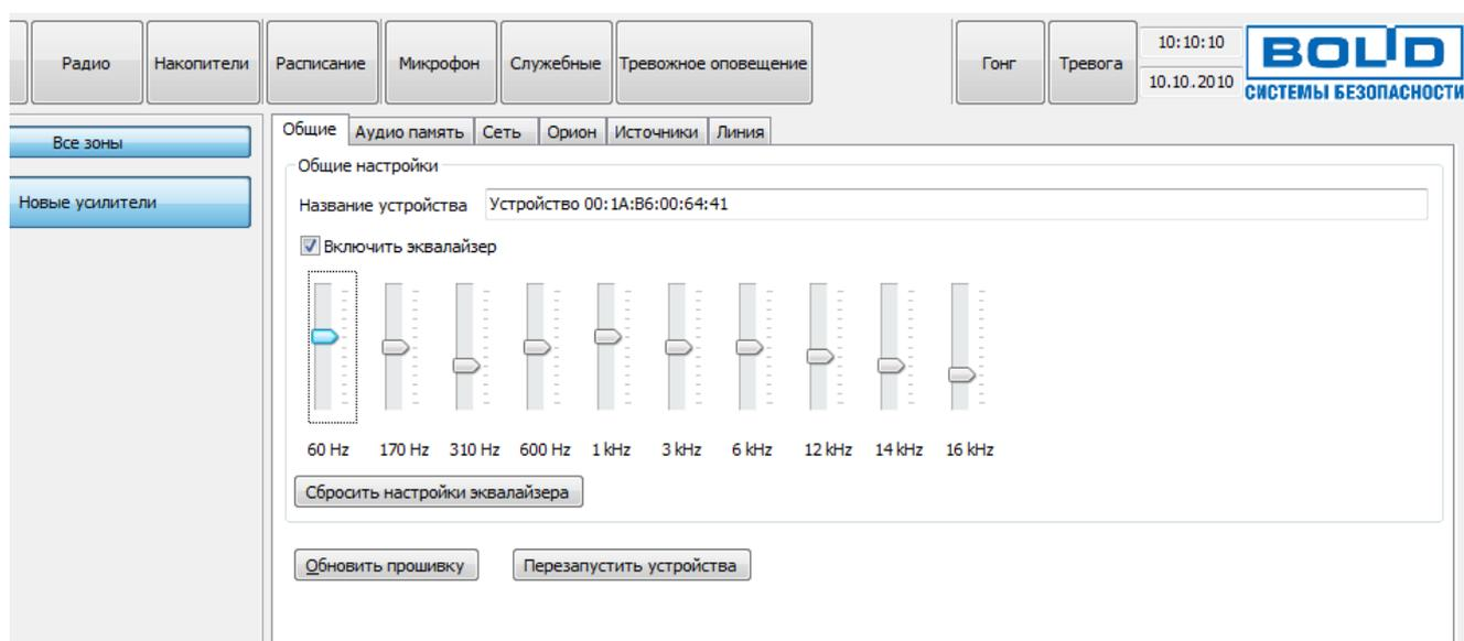
Рисунок 2.2.18. Обновление прошивки блока через ПО «Аудио сервер»
