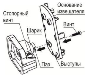
4.1 Сделать разметку крепежных отверстий на несущей поверхности по приложенному кронштейну.
